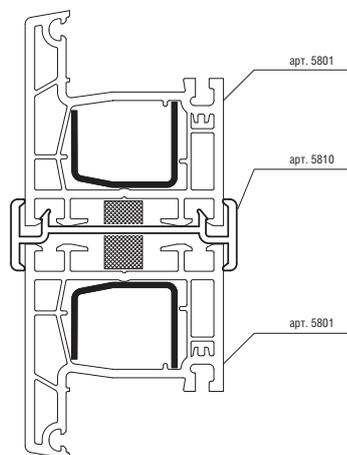
2.2.7 Комбинация с использованием расширительного профиля 35 мм арт. 5812
