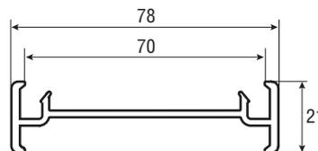
**3.1.11 Профиль расширительный 35 мм
