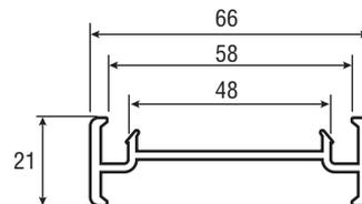
**2.1.9 Профиль расширительный 35 мм
