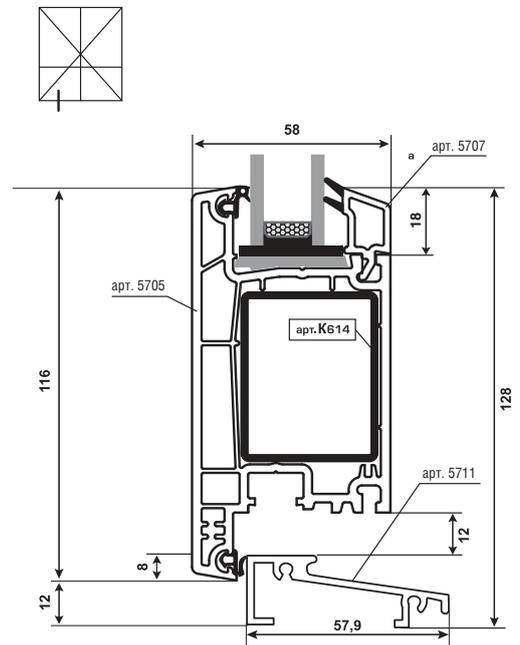
5.1 Система входных дверей KRAUSS серии 7300 (трехкамерная с наружным уплотнением)
