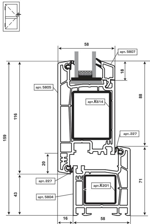
**4.3.3 Комбинация «дверная створка арт. 5805 - импост арт. 5803 - дверная створка арт. 5805 - штапик 14 мм арт. 5807»**
