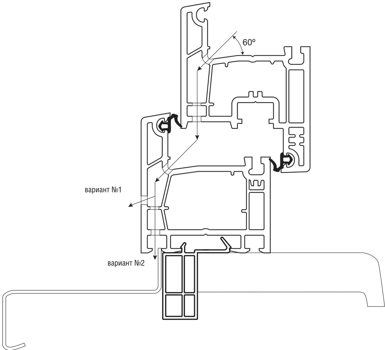
12.6 Схема водоотвода в импосте
