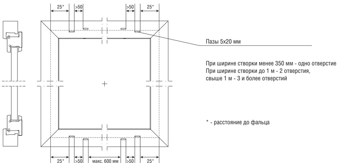
**12.3 Отверстия для компенсации ветрового давления и отвода воды в раме**
