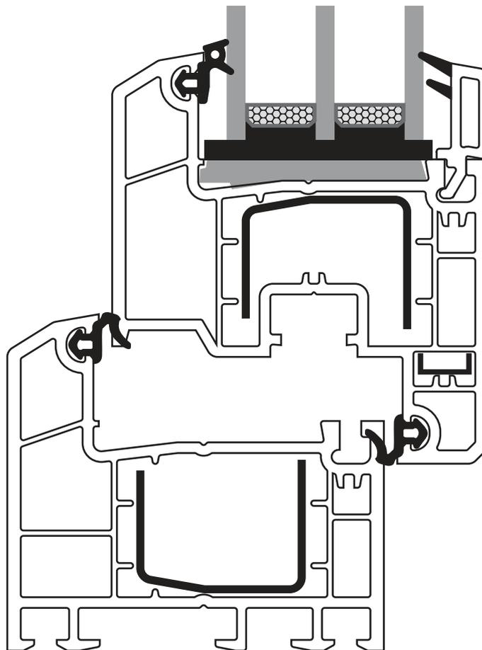
1. Улучшенная теплозащита благодаря 70-миллиметровой монтажной ширине. Возможность установки более широких, до 40 мм, стеклопакетов в более глубокий фальц
