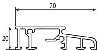
**5.2.6 Соединитель дверной рамы и порога
