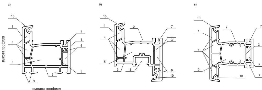
а) поперечное сечение профиля рамы б) поперечное сечение профиля створки
