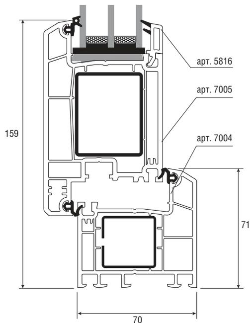
**5.3.3 Комбинация «дверная створка арт. 7005 - импост арт. 7009 - дверная створка арт. 7005 - штапик 7 мм арт. 5816»**
