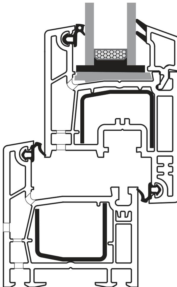
1. В створке устанавливаются одно/двухкамерные стеклопакеты до 32 мм
