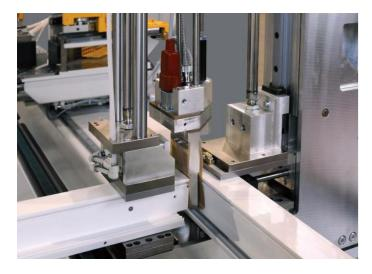
Сваривание импостов встык с помощью профилированного сварочного зеркала.
