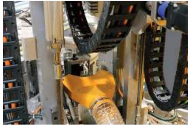
Опционально: Зачистной автомат с вытяжкой стружки
