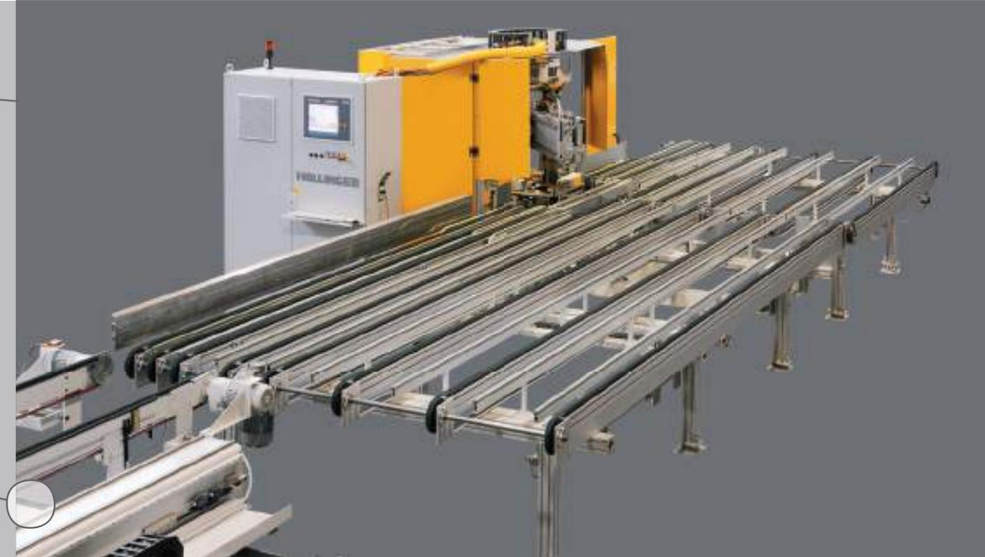
Абсолютно синхронное сведение профилей посредством механического соединения привода и двух соответствующих стальных направляющих. Удобный доступ оператора к машине. Высочайшая точность сваривания обеспечивается также за счёт соединения верхних прижимов с рабочим столом. Инструмент для сварки рам интегрирован в машину. Электронное позиционирование всех сварочных агрегатов осуществляется с помощью промышленного персонального компьютера с сенсорным монитором.
