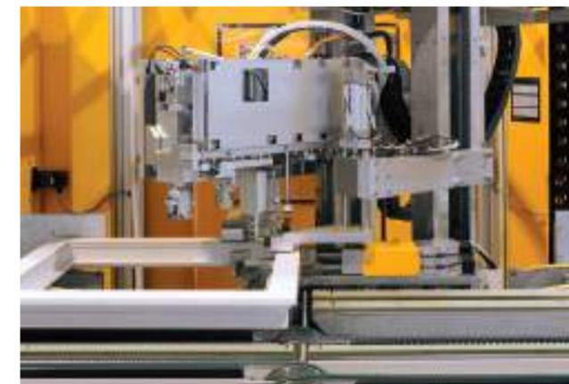
Автоматический поворот обрабатываемых заготовок
