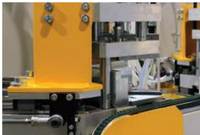
Highlight: замок сварочной головки верхнего ножа, с помощью которого цветные профили могут свариваться сверху также с ограничением шва 0,2 мм
