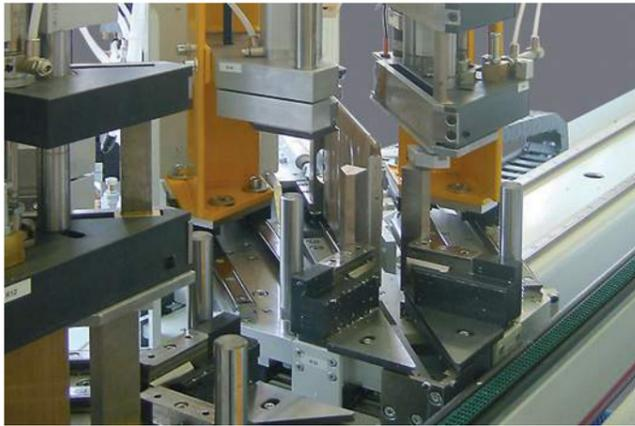
Опционально: Формирователь уплотнителя, работающий в двух направлениях, позиционируется сервомотором
