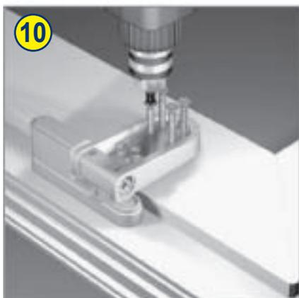
10 Крепление шурупами 6,3 мм створочной части петли.
