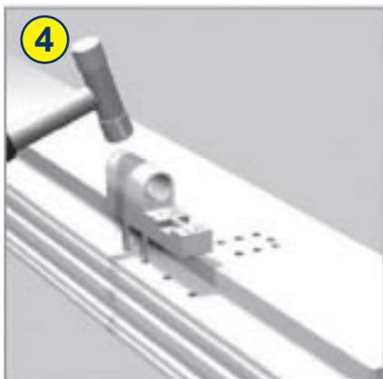
4 Позиционирование рамной части петли.
