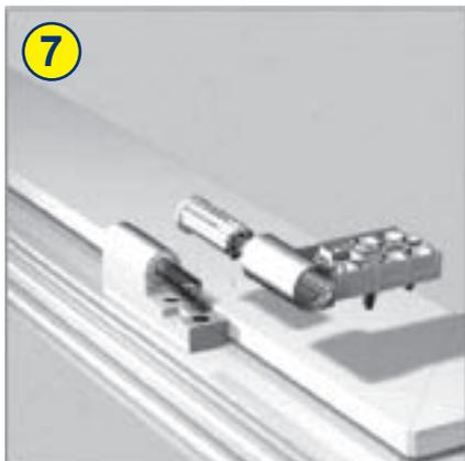
7 Установить эксцентриковую втулку створочной части петли  $\pm 0,75$  мм. Обратите внимание на маркировку штифтмодуля. В каждой петле привести маркировку штифтмодуля в одинаковое положение.
