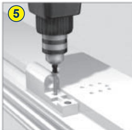
5 Крепление рамной части петли с помощью входящих в комплект шурупов 6,3 мм.
