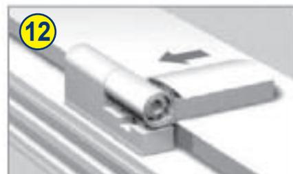
12 Задвинуть декоративную накладку створочной части и обезопасить от несанкционированного демонтажа с помощью входящего в комплект предохранительного винта.
