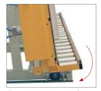
Пневматически-откидная опорная роликовая консоль
