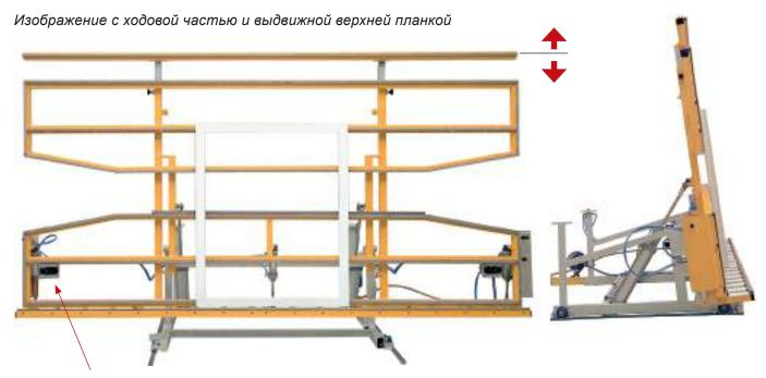
Пневматический фиксирующий цилиндр
